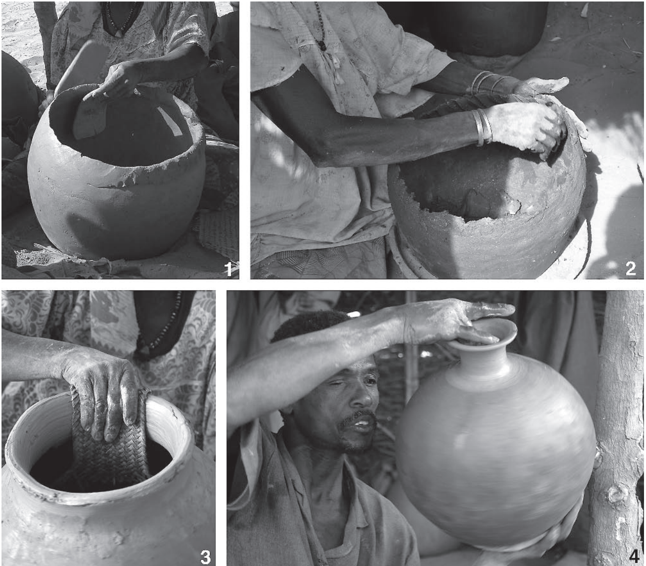
Fig. 4 – Façonnage de la partie supérieure de la panse et du col : 1) battage avec une batte en bois et un morceau de plat en bois comme contrebatte ; 2) raclage avec un morceau de calabasse ; 3) préformage du col par lissage avec un morceau de natte ; 4) préformage du col et de la lèvre à main nue. Fig. 4 – Shaping of the upper part of the body and the neck: 1) beating using a wooden paddle and a piece of wooden dish as backstop; 2) scraping with a piece of calabash; 3) pre-forming of the neck by smoothing with a piece of mat; 4) pre-forming of the neck and the lip by hand.
