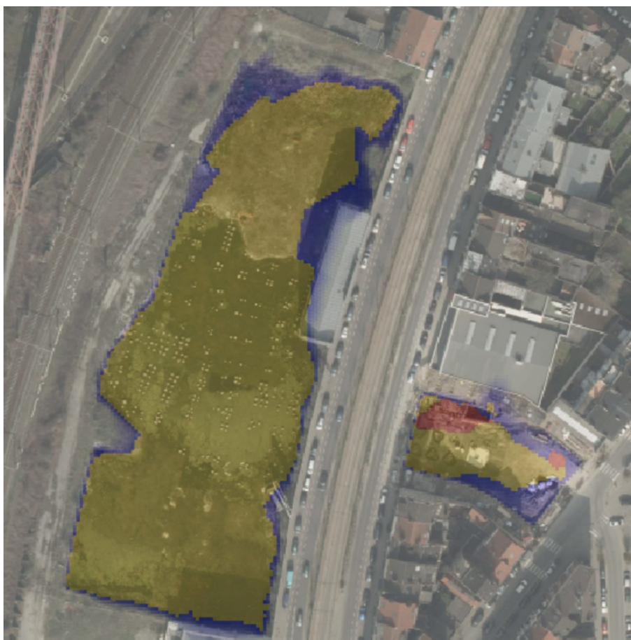
Fig. 7 : Données INSPIRE – Modèle numérique de terrain, 2012 traitées en SIG (légende : rouge < 18.49 m < jaune < 18.51 m < bleu < 19 m < blanc), en transparence sur l'orthophotoplan de 2012 19
