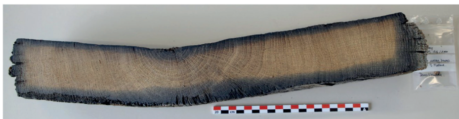
Section d'une planche en bois de chêne, prélevée au niveau du radier de fondation du chœur de l'ancienne église Saint-Géry à Bruxelles. Fouilles de la SRAB en 1990. © Photographie de travail, KIK-IRPA
