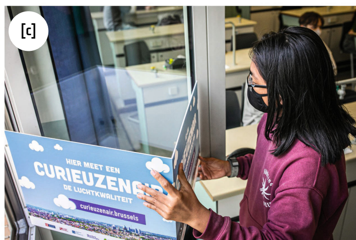
Figuur 1. Meetopstelling gebruikt in het CurieuzenAir project. (a) Meetprocedure voor \text{NO}_2 in de buitenlucht via Palmes diffuse buisjes. Twee meetbuisjes, geïnstalleerd in de punt van het bord, meten gedurende vier weken de \text{NO}_2 concentratie in de straat. (b) Demonstratie van het in een van de 83 scholen die participeerden in het project. (c) Installatie van een meetbord aan het raam van een van de CurieuzenAir meetlocaties.
