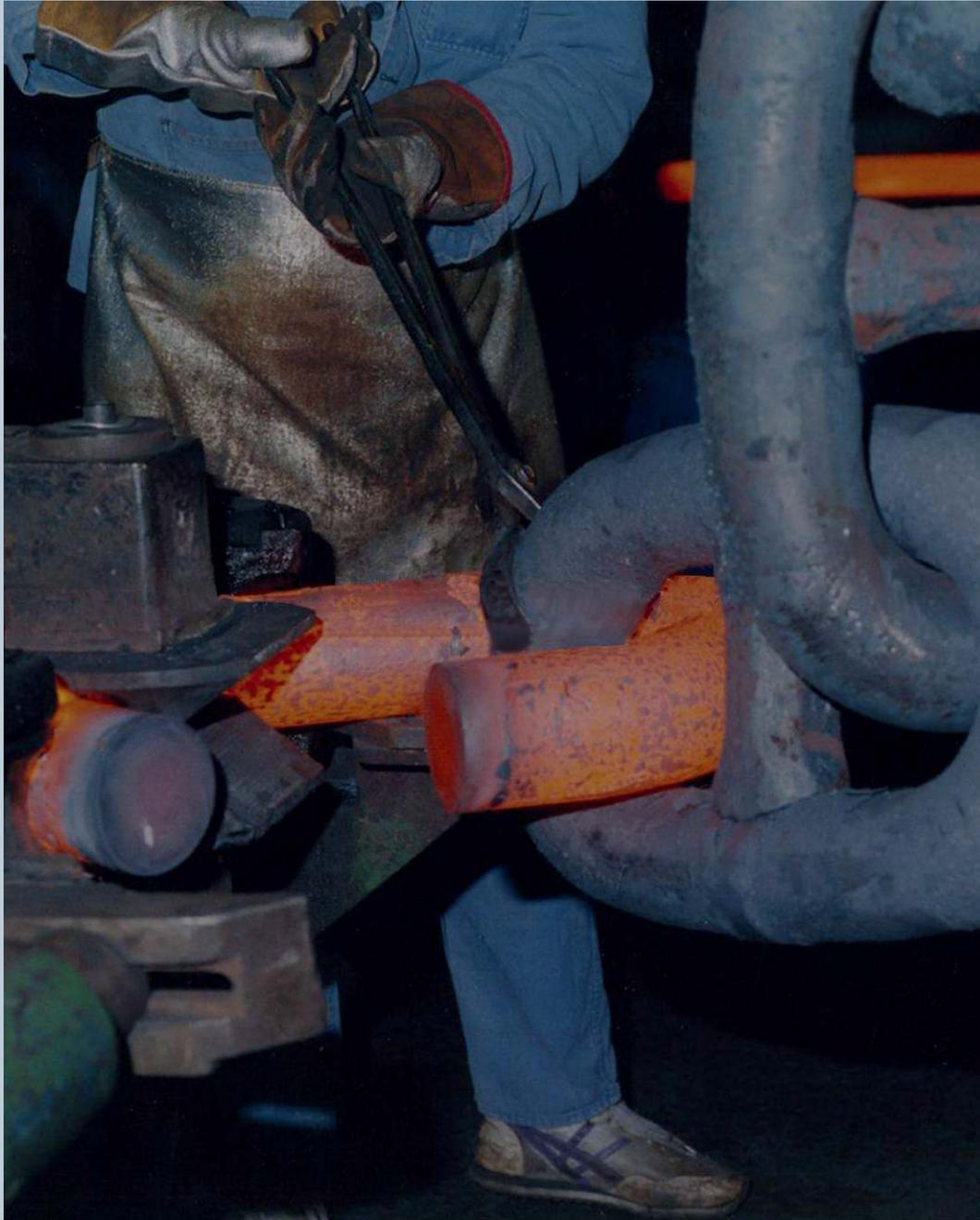
3. **Chaîne de mouillage en cours de fabrication**
