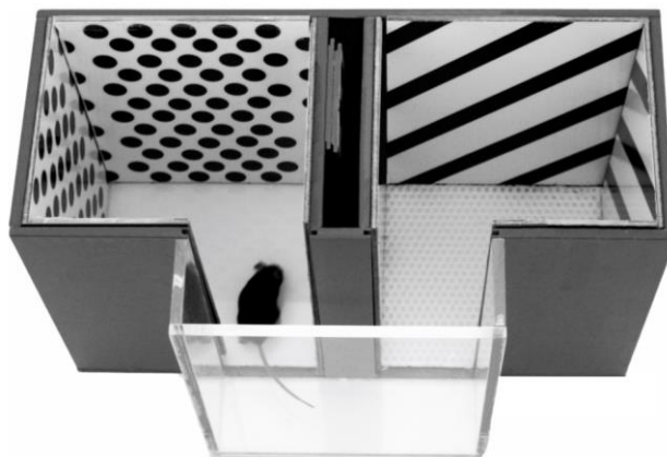
Figure 28 : Photographie du dispositif utilisé lors d'un test de conditionnement de préférence de place. Adapté de Laurie Lambot 2015.
