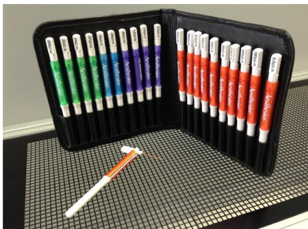
Figure 27 : Photographie d'un set de filaments de Von Frey utilisé dans l'étude de l'allodynie. Adapté de Ugo Basile Von Frey Hairs.
