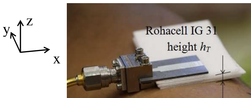
Figure 2.24 Antenne mesurée à différentes hauteurs h_T au-dessus de la surface du corps.
