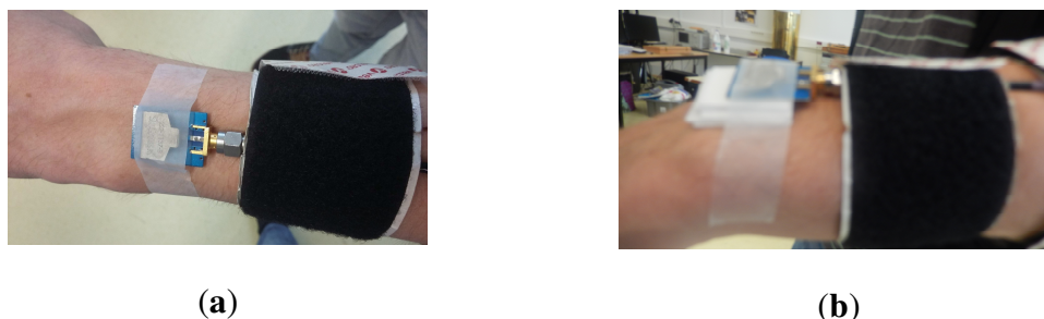
Figure 4.10 Antenne SkyCross sur le poignet gauche (a) h = 0 mm, (b) h = 5 mm.
