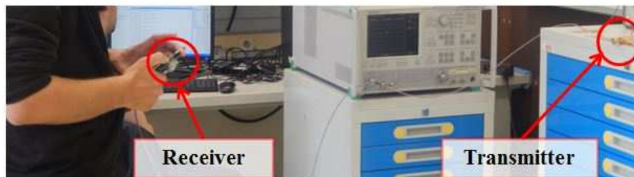
Figure 4.7 Mesures entre une antenne cornet SIW attaché sur le téléphone et une antenne guide d'onde distante.
