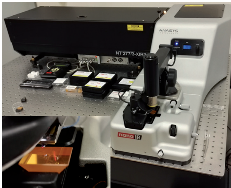
Figure 3 : Photo du nanoIR de Anasys Instruments. La partie noire à gauche de l'équipement est le laser infrarouge. L'AFM est en gris sur le côté droit de l'équipement. En bas à gauche, une photo centrée sur le prisme en ZnSe où l'échantillon est déposé et la pointe d'AFM au-dessus.
