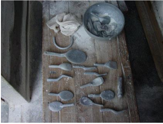
Figure III.2-8 Lisoirs spéciaux conçus par SMOAC
