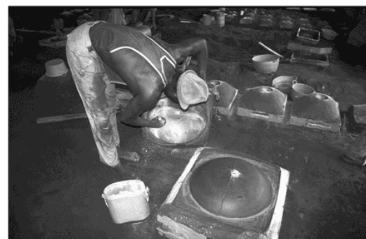
Figure II-24 Dépose de la partie supérieure du moule
