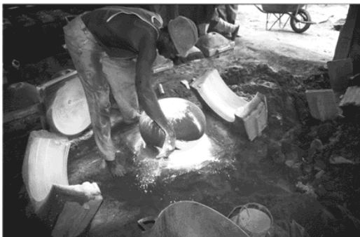
Figure II-26 Démontage complet du moule
