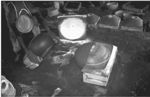
Figure II-25 Démontage des demi-cadres inférieurs
