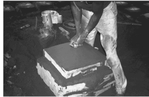
Figure II-22 Préparation de l'orifice de coulée
