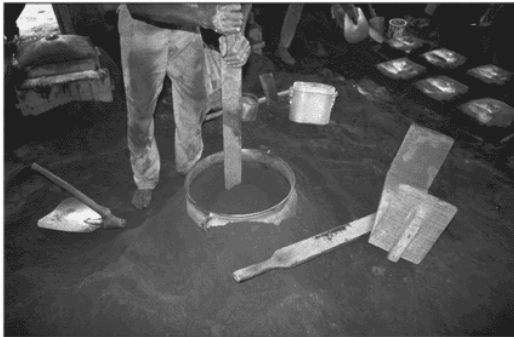
Figure II-15 Préparation de l'empreinte interne (noyau) du modèle
