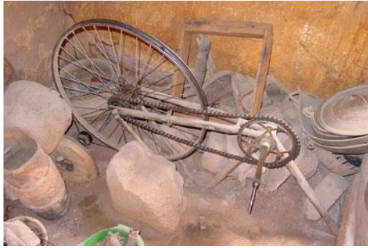
Figure III.2-3 Cadre de vélo servant à entraîner la soufflerie
