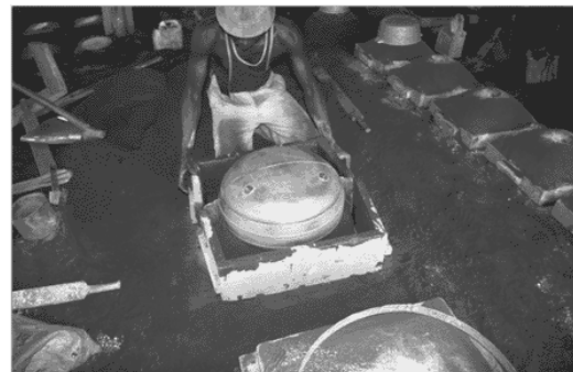
Figure II-18 Mise en place des demi-cadres inférieurs
