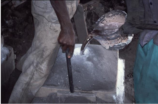
Figure III-6 Coulage de l'aluminium en fusion dans le moule
