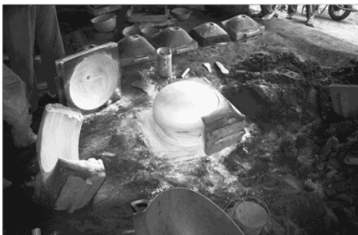
Figure II-27 Pose du demi-cadre inférieur
