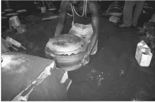
Figure II-14 Assemblage du modèle
