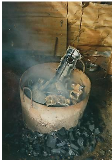
Figure III-4 Les plus grosses pièces d'aluminium sont mises à fondre
