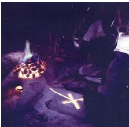
Figure II-10 Coulage d'une croix de cuivre dans un moule ouvert. (source inconnue).
