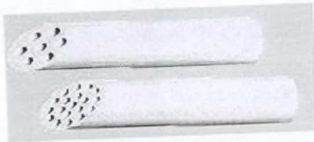
Fig. 3.61. Vue du filtre céramique poreux de type MicroKerasesp (Rhône Poulenc).
