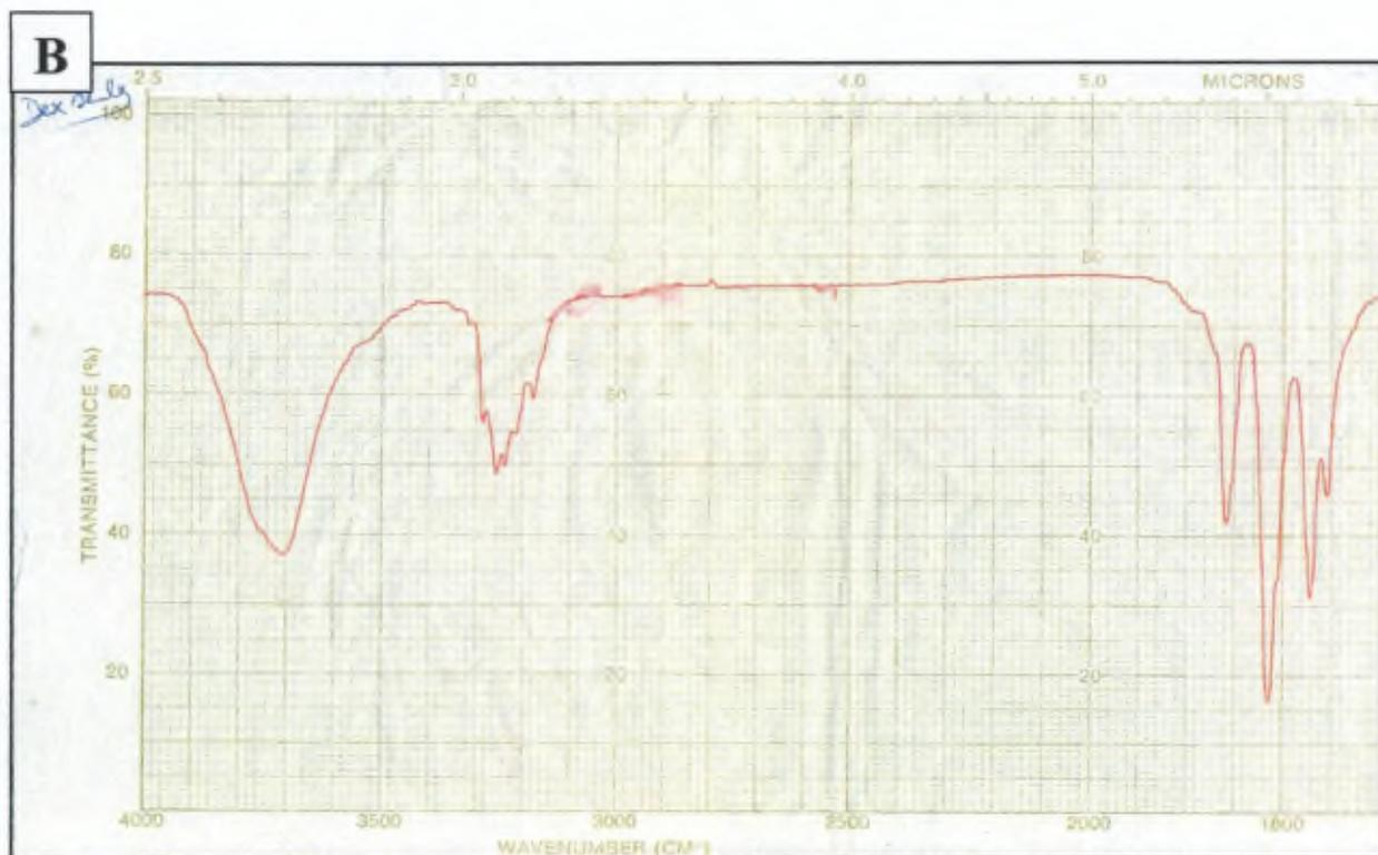
Fig. 3.2 B) spectre IR de la DXM utilisée pour la synthèse.
