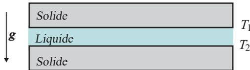
FIGURE 1.11 – Schématisation de l'expérience de Rayleigh-Bénard. Les interfaces liquide-solide supérieure et inférieure sont respectivement à la température  $T_1$  et  $T_2$ .
