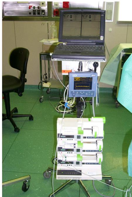
FIGURE 7.6 – Exemple d’un chariot utilisé à l’hôpital Erasme, composé de trois pompes pour les différentes drogues, d’un moniteur d’inconscience BIS et d’un ordinateur sur lequel ITB est configuré.
