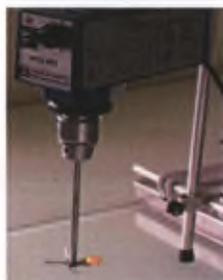
**Figure 44:** Photographie de l'agitateur à hélice
