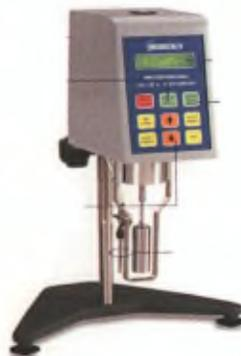
**Figure 45 :** Photographie d'un viscosimètre Brookfield
