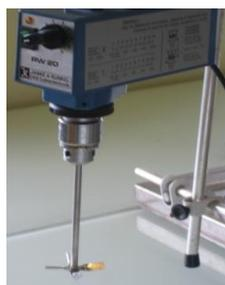
**Figure 44:** Photographie de l'agitateur à hélice
