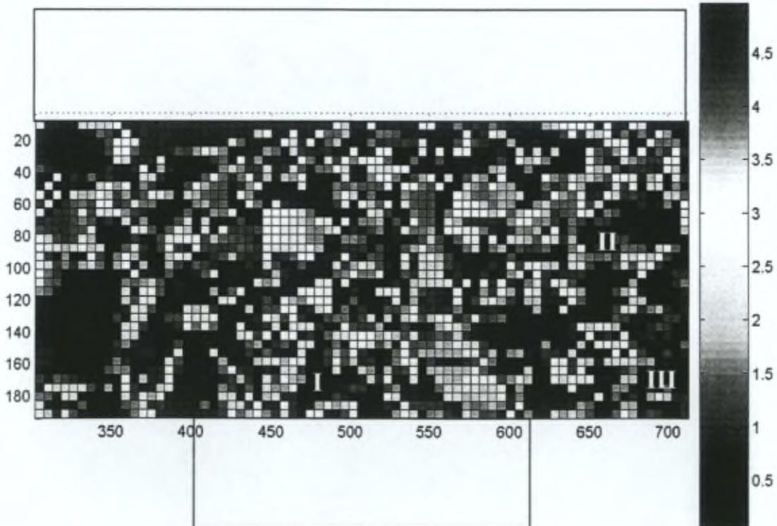
Figure 94 : Second invariant du tenseur des déformations  $|I_{2\varepsilon}| > 0.05 [-]$ , itération 0 – 10 kPa, détail au niveau de l'inclusion. Unité des axes : mm.
