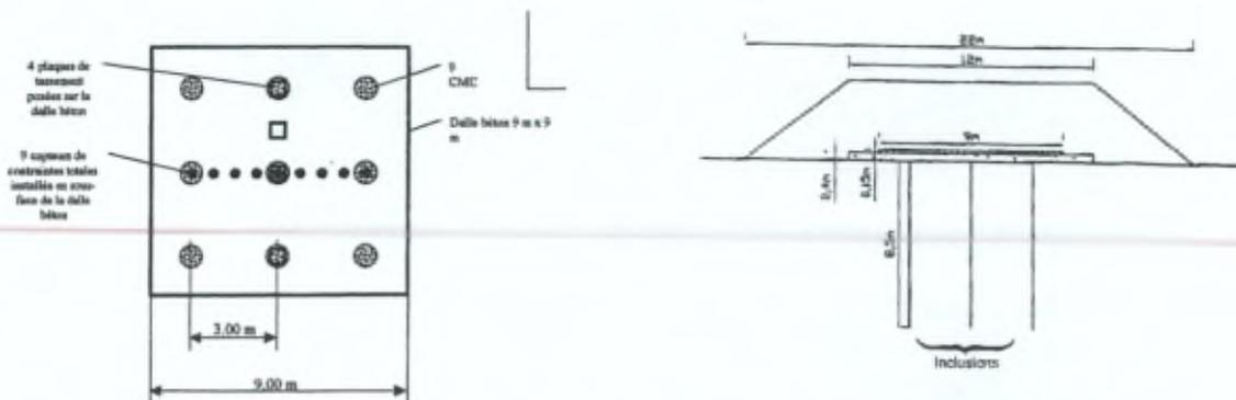
Figure 19 : vue en plan et coupe du plot expérimental d'Agen, d'après Berthelot & al. (2003).
