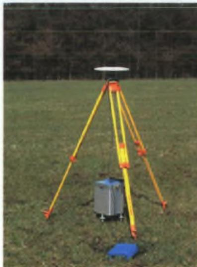
FIGURE 5-8 : GRAVIMÈTRE SCINTREX CG-5 ET DGPS TRIMBLE.
