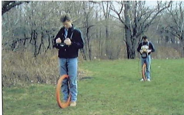
FIGURE 5-9 : EM-34 EN OPÉRATION. PHOTO DE GEONICS LTD.
