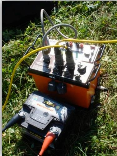
FIGURE 5-3 : APPAREILS DE MESURE ABEM (SAS1000 ET ES464)
