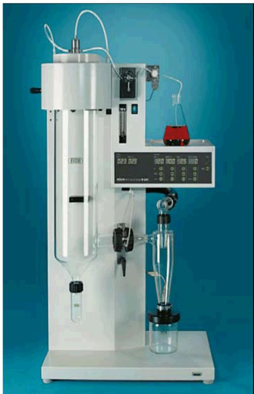
**Figure 9:** Büchi - mini Spray-Dryer B290
