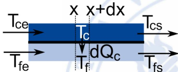
$$Ud\Omega(T_c - T_f) = -M_c C_{pc} dT_c \quad (265)$$
